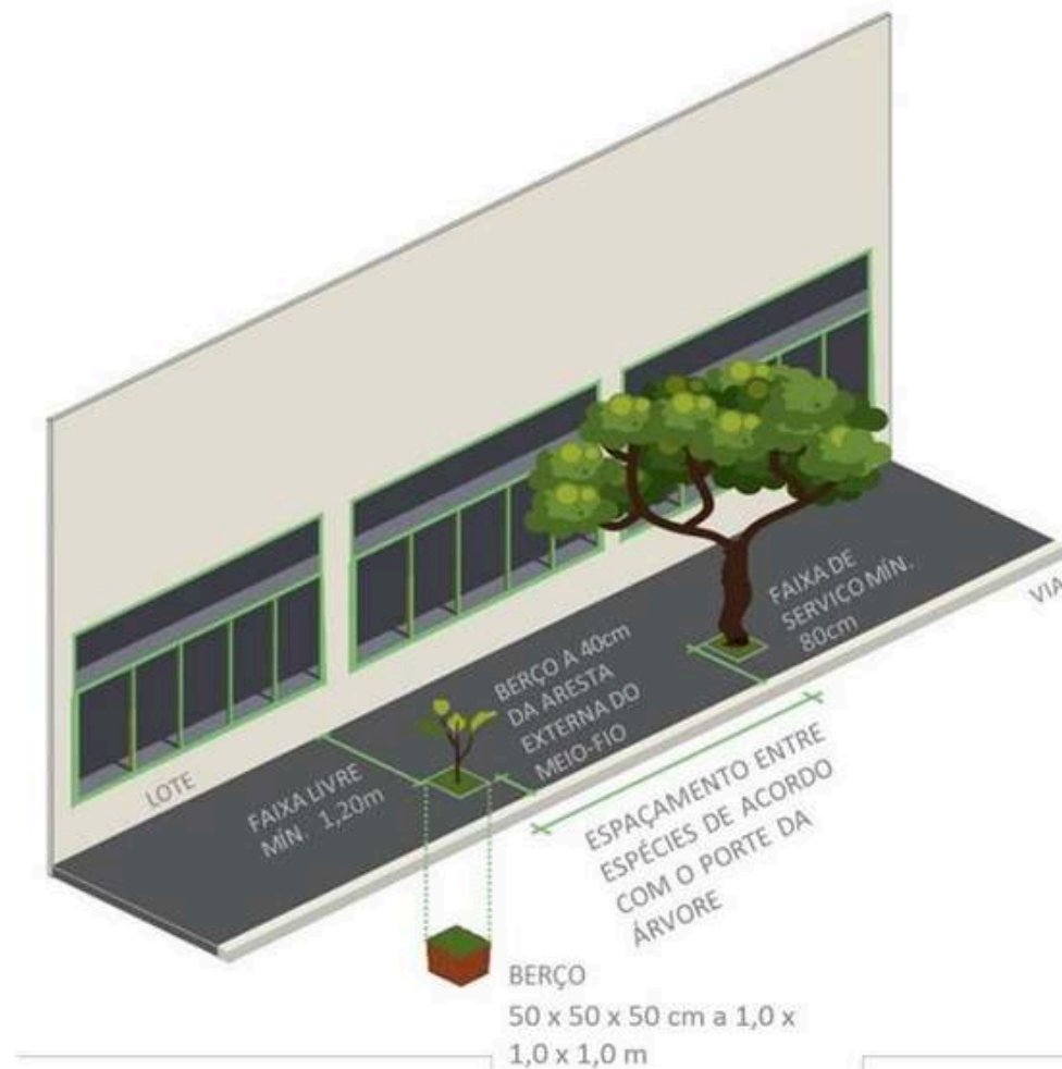
Figura 16 - Dimensões consideradas no plantio de árvores para Fortaleza.
