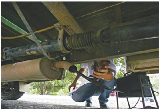
Uma das ações foi a blitz montada na Avenida Godofredo Maciel, na Maraponga, que verificou a quantidade de fumaça emitida pelos motores dos veículos. Se o nível for acima do permitido, o motorista é autuado. FOTO: NATIHO RODRIGUES
