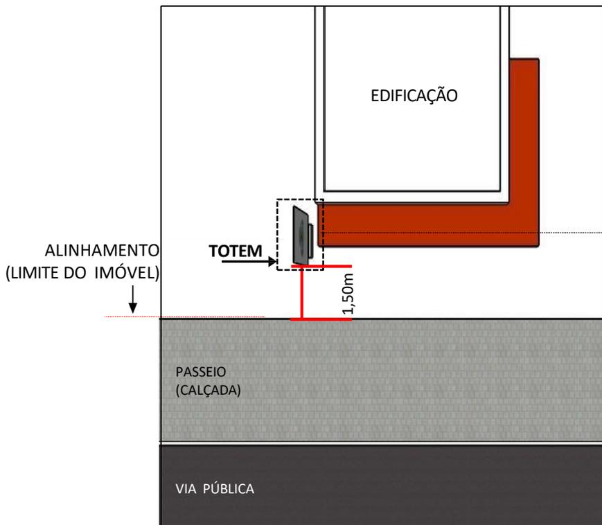
O totem deverá ser instalado a 1,50m a partir do limite do imóvel (alinhamento) livrando totalmente o passeio (calçada).
