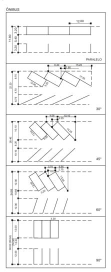
0,00 m - LARGURA DA VIA NA VAGA DE FRENTE (0,00)m - LARGURA DA VIA NA VAGA DE MARCHA A RÉ
