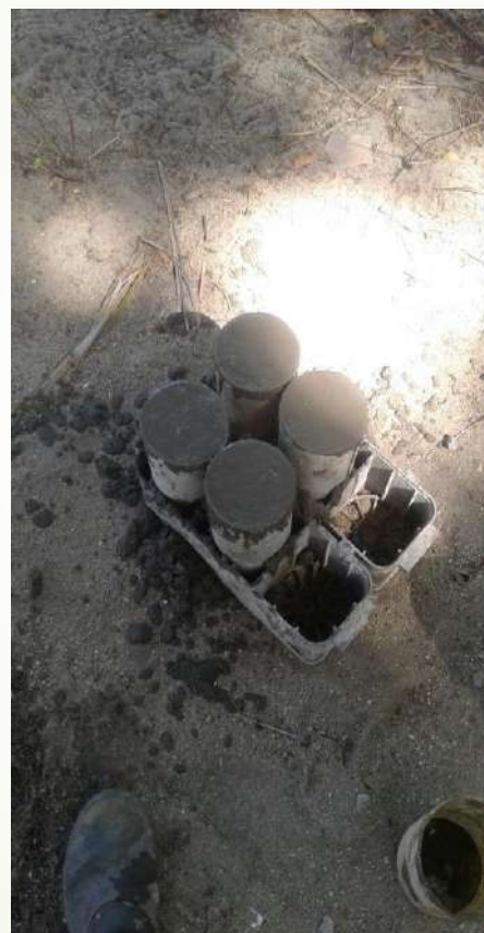
Figura 21. Corpo de prova de concreto(meio-fio).
