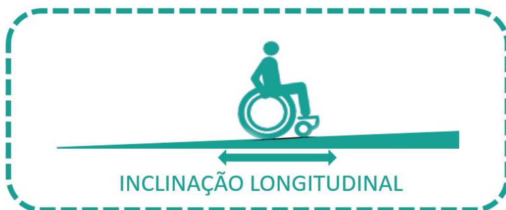
FIGURA 17. Inclinação longitudinal de calçadas.
