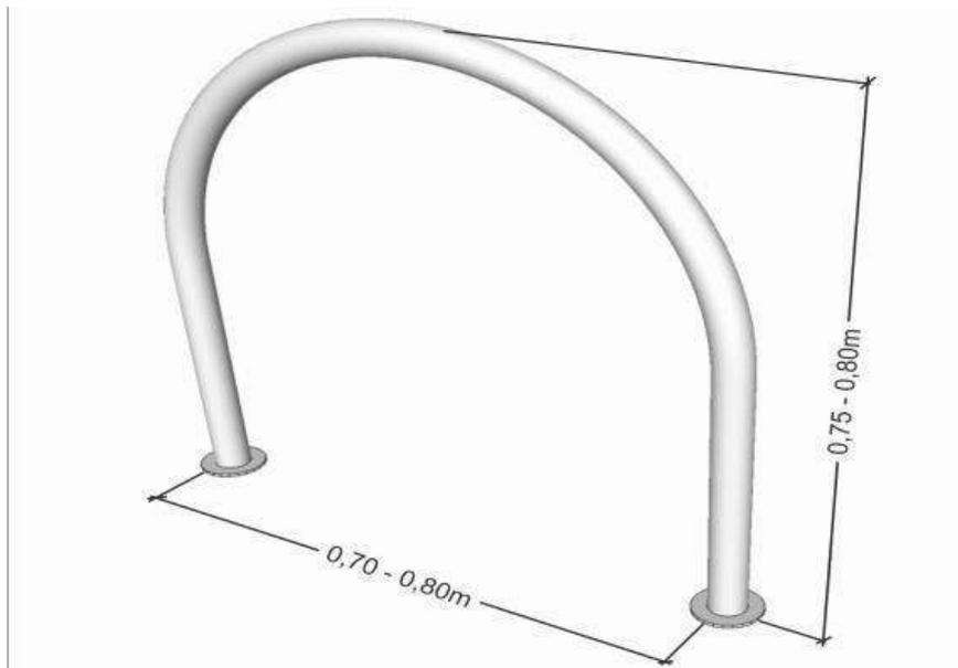
Figura 15 - Modelo padrão de paraciclo a ser utilizado nos logradouros públicos.
