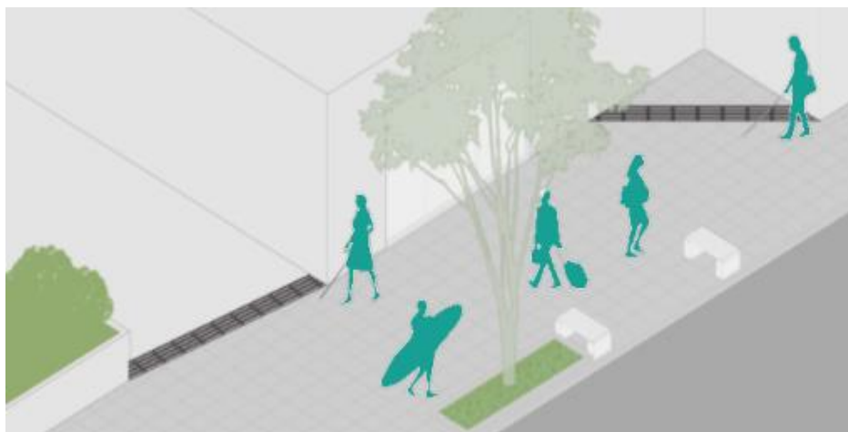
Exemplo de aplicação de piso tátil.
